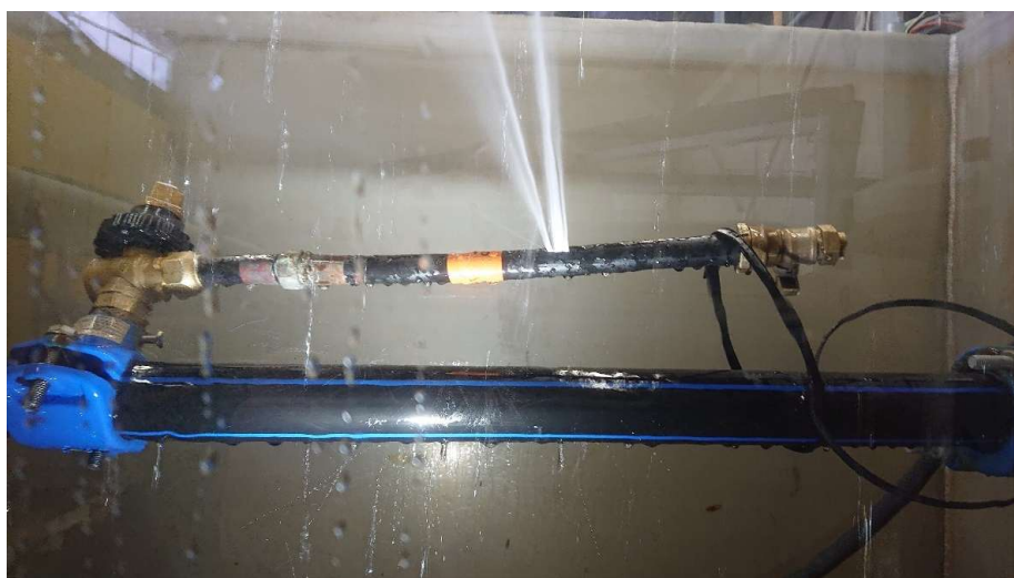
Photo 1 : Montage pour la mesure dans le caisson eau des pertes sur un branchement
